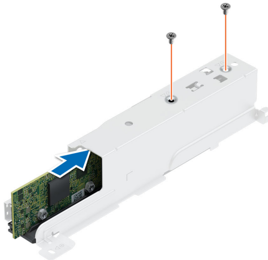
Ilustración 59. Instalación de la tarjeta BOSS N1
